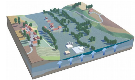
Inondation par remontée de nappe
